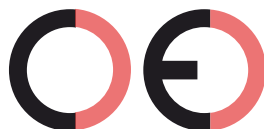
Falsche CE-Kennzeichnung (zu großer Zwischenraum)
