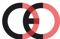
Falsche CE-Kennzeichnung (zu dicht)
